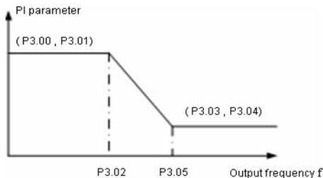
Figure 6.9 PI parameter diagram.
