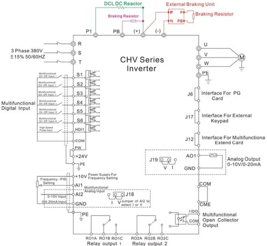
Figure4. 8 Wiring diagram.
